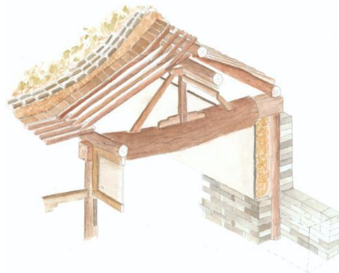
Charpente triangulée du temple de type « tai-liang »
